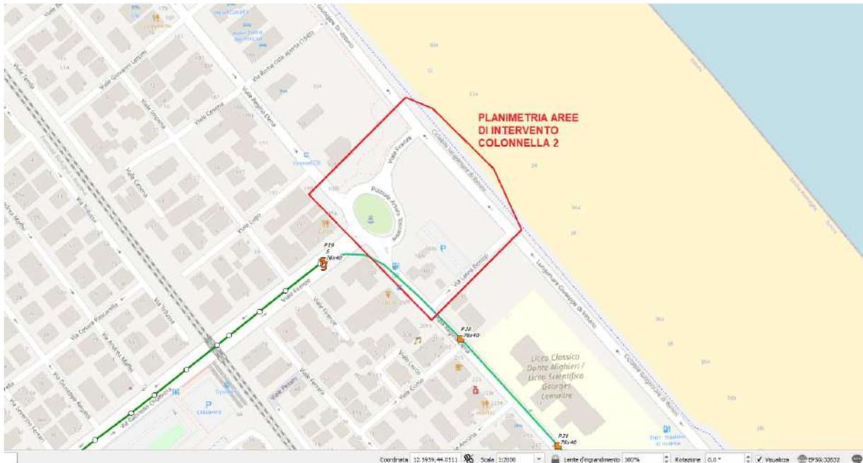
Si segnala la presenza di n.1 cavo da 144 fibre ottiche di proprietà Lepida ScpA posato in uno dei due monotubi di diam. 50mm, infrastruttura realizzata mediante posa interrata NO-DIG su strada Viale Firenze e Viale Regina Elena, infrastruttura di proprietà Lepida ScpA (vedi tratto di colore verde/azzurro).
