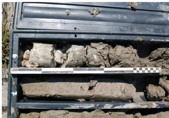
Fig. 8. Sondaggio BH5, particolare dei frammenti di conglomerato a quota – m 5,80 ca.
