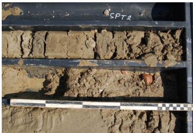
Fig. 7. Sondaggio BH2, particolare delle ghiaie e laterizi presenti a quota – m 7,90 ca.
