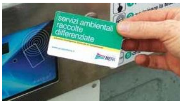
Figura 13: La card elettronica con transponder
