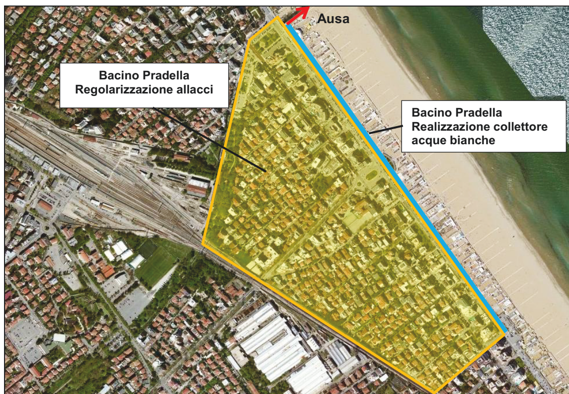
Figura 9.10. Interventi di sistemazione nel bacino del Pradella
